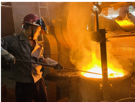
▲伴着炽热铁水奔涌而出,铸锻公司铸造工厂黑区产线的浇注工人顶着灼热气浪,于汗水与热浪交织中做好炉前除渣工作,以精准操作护航铁水温度工艺。
